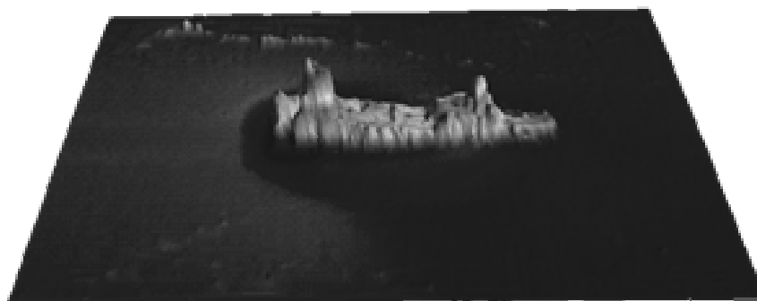
rys. 2. Numeryczny model dna z widocznym wrakiem wystającym ponad linię dna.
