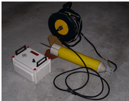
rys. 3. Magnetometr protonowy. Widoczna biała konsola, żółta sonda wraz z kablem na bębnie oraz krótki kabel łączący bęben z konsolą. Źródło zasilania umieszczone wewnątrz konsoli. Po lewej stronie konsoli widoczny włącznik, po prawej przełącznik zakresu pomiarowego indukcji pola magnetycznego.
