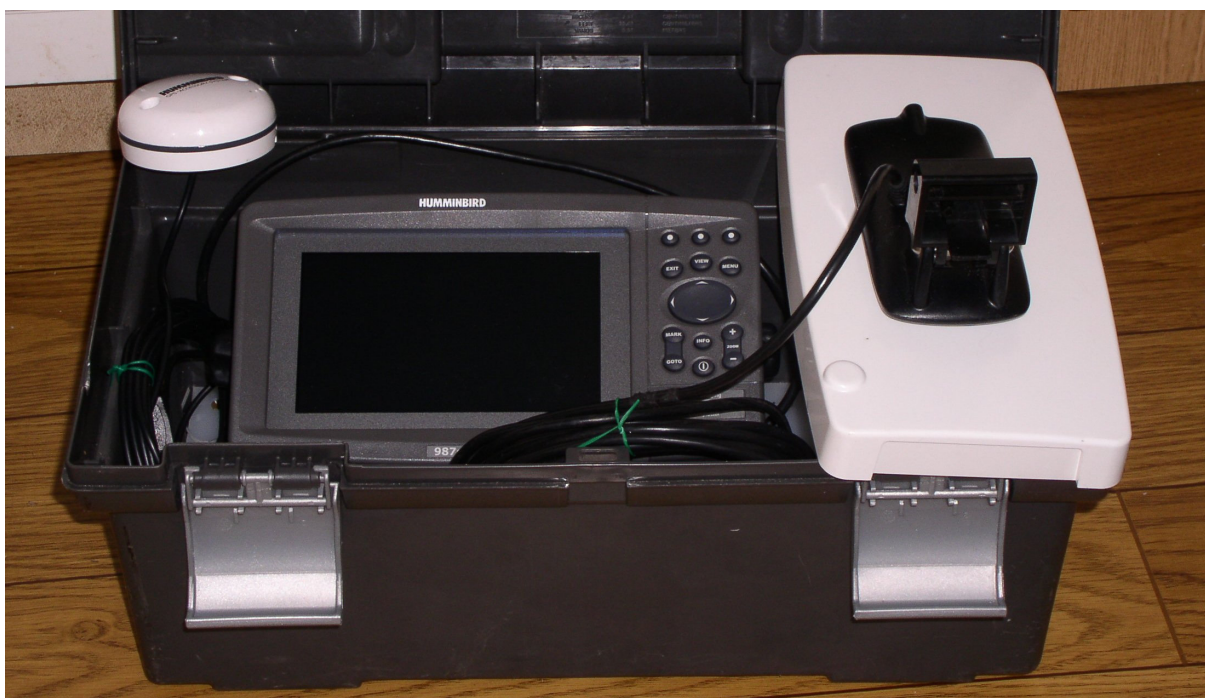
Rys. 1. Sonar Humminbird 987c. Po lewej stronie widoczna antena odbiornika GPS. Przetwornik sonaru i echosondy po stronie prawej, na białej pokrywie konsoli. Pod przetwornikiem akumulator zasilający (niewidoczny). Całość zabudowana w przenośnej skrzynce plastikowej ułatwiającej transport zestawu.
