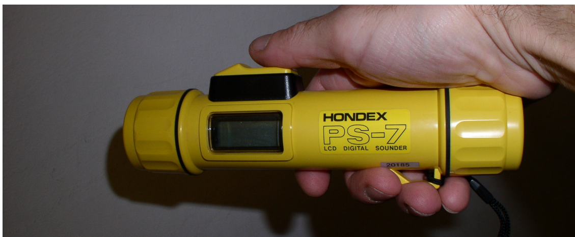
Rys. 2. Echosonda ręczna. Widoczny wyświetlacz LCD oraz włącznik monostabilny, którego przesunięcie powoduje wykonanie pojedynczego pomiaru. Jeżeli przycisk nie zostanie przesunięty ponownie w czasie 15 s, echosonda przechodzi w stan uśpienia.
