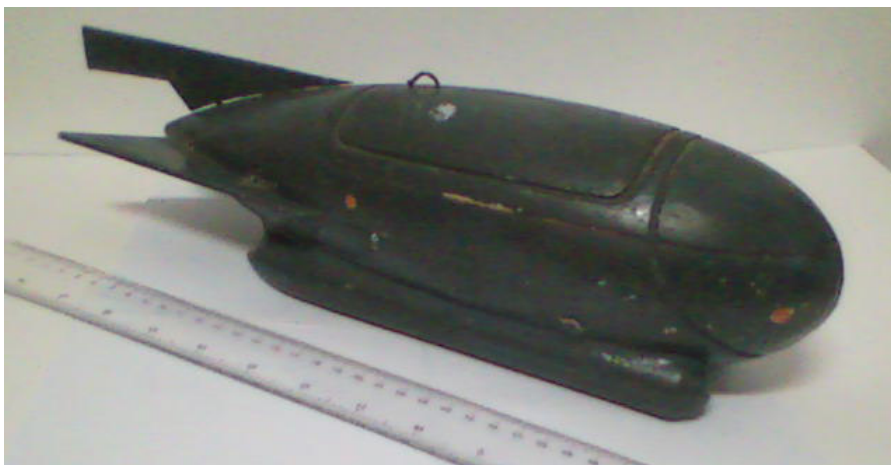
Rys. 3. Model pojazdu do badań oporów ruchu
