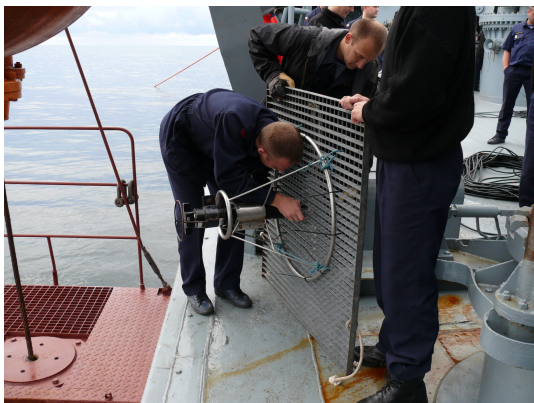
Rys. 9. Montowanie głowicy sonaru do podestu nurkowego
