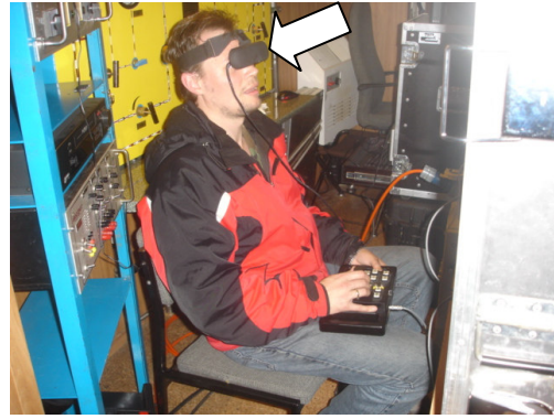
Rys. 18. Pilot pojazdu ROV z nagłownym podsystemem zobrazowania wchodzącym w skład systemu ARGOOS
