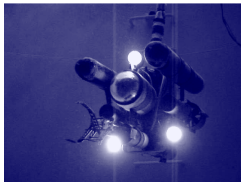
Rys. 13. Mini ROV „Gammarus” w położeniu podwodnym.
