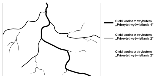
Ryc. 8. Przykład wizualizacji danych z wykorzystaniem atrybutu „priorytet wyświetlania” ( Display priority ) lub „klasa wyświetlania” ( Display class )
