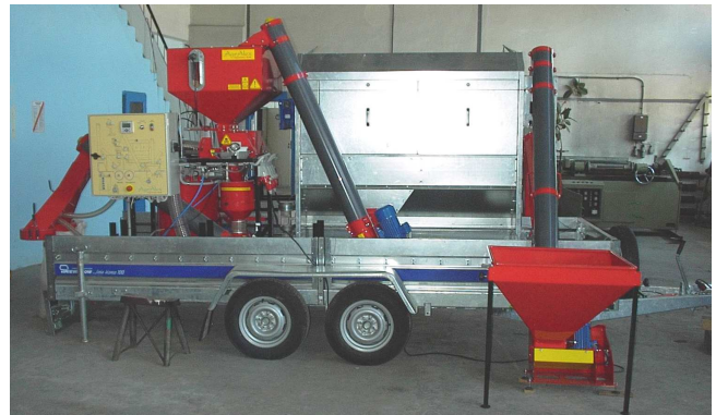
Rys. 1. Innowacyjna mobilna linia technologiczna do przygotowania ziarna siewnego zbóż „ANIELA” w pozycji roboczej
