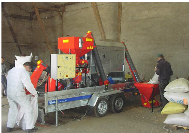
Rys. 4. Innowacyjna mobilna linia technologiczna do przygotowania ziarna siewnego zbóż „ANIELA” w trakcie badań funkcjonalnych
