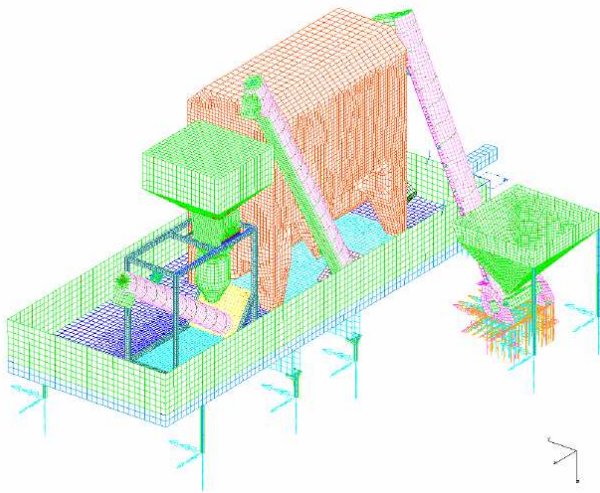
Rys. 3. Model obliczeniowy linii technologicznej – widok od tyłu
