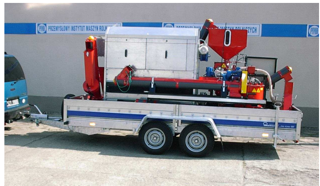
Rys. 2. Innowacyjna mobilna linia technologiczna do przygotowania ziarna siewnego zbóż „ANIELA” w pozycji transportowej
