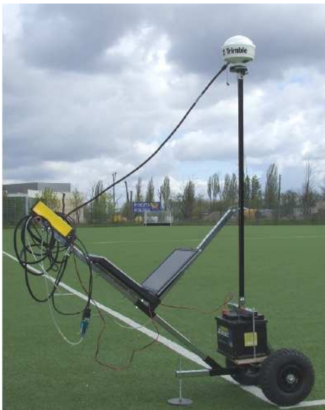
Rys. 2. Wózek pomiarowy z zamontowanym odbiornikiem GPS i komputerem Fig. 2. Measurement trolley with mounted GPS receiver and computer
