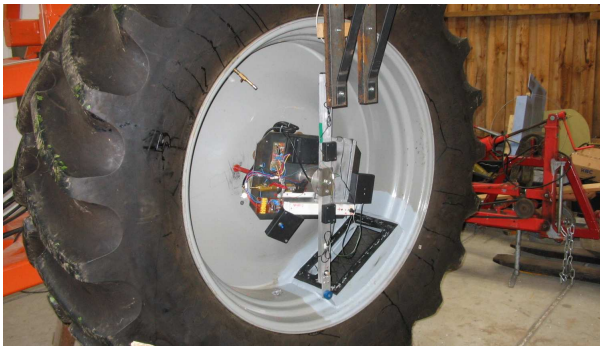
Rys. 4. Widok koła przed montażem czujnika ultradźwiękowego
