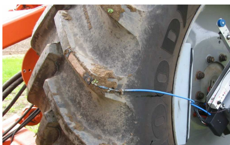
Rys. 9. Widok zamontowanego czujnika pomiarowego Fig. 9. Installed measurement sensor
