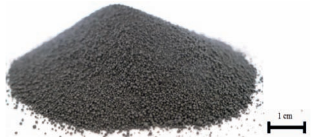
Rys. 7. Granulowana zasympka krystalizatorowa zastosowana w procesie ciągłego odlewania stali
