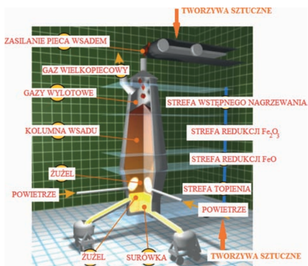
Rys. 16. Schematyczne przedstawienie możliwości wprowadzenia odpadów z tworzyw sztucznych do wielkiego pieca [7]
