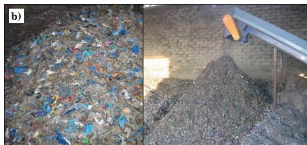
Rys. 3. Paliwo alternatywne z tworzyw sztucznych: a) odpady przed rozdrobnieniem, b) paliwo alternatywne [12]
