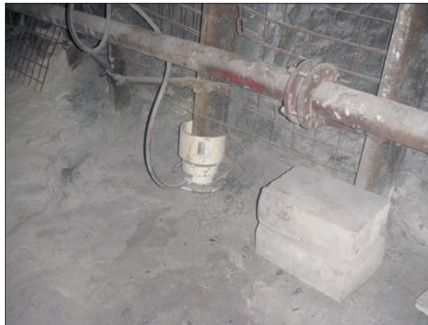
Rys. 24. Odrzwia SPŁ6.8-7.2/3.5/V29 ze stali S550 zabudowane w chodniku nadścianowym 3-Z1,Z2 w pokładzie 510/2 w KWK „Jas-Mos”
