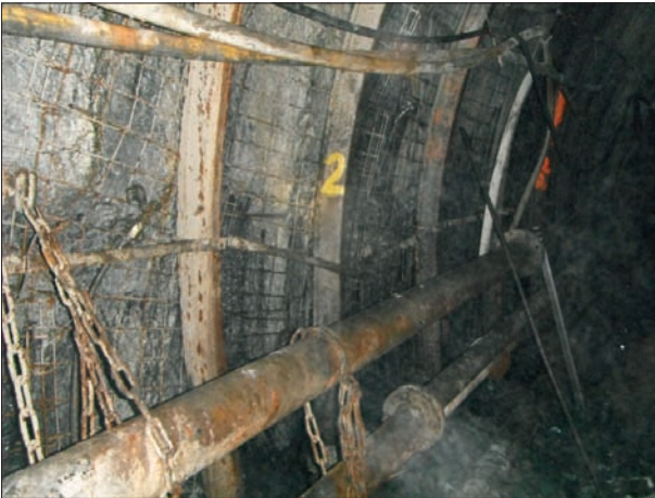
Rys. 22. Odrzwia ŁPw zabudowane w dowierzni 3. badawczej w pokładzie 504 w KWK „Bobrek-Centrum”
