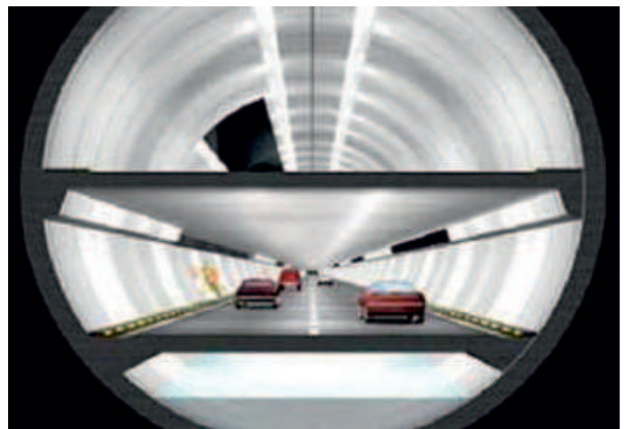
Rys. 3. Schemat graficzny wyjaśniający przekrój tunelu i jego wykorzystanie [11].
