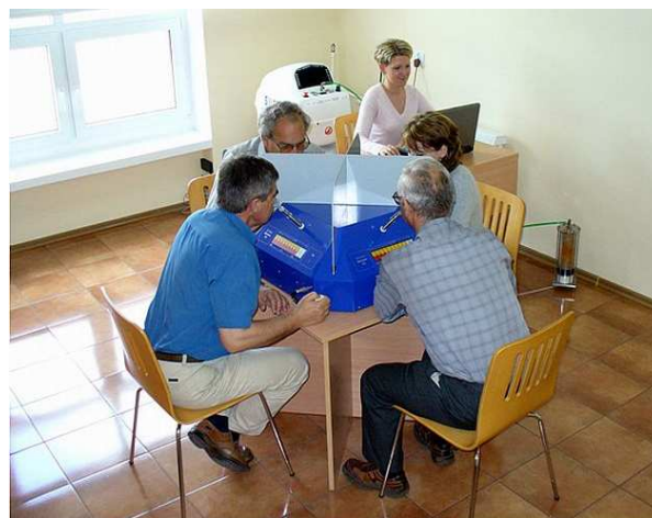
Rys. 1. Pomiary olfaktometryczne stężenia odorów Fig. 1. Odour concentration was assessed in the laboratory using dynamic olfactometry
