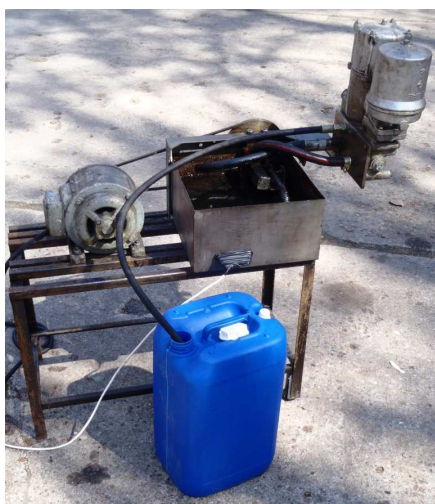
Rys. 1. Instalacja do filtrowania zużytego oleju własnego pomysłu Fig. 1. Own concept of the installation for waste oil filtration
