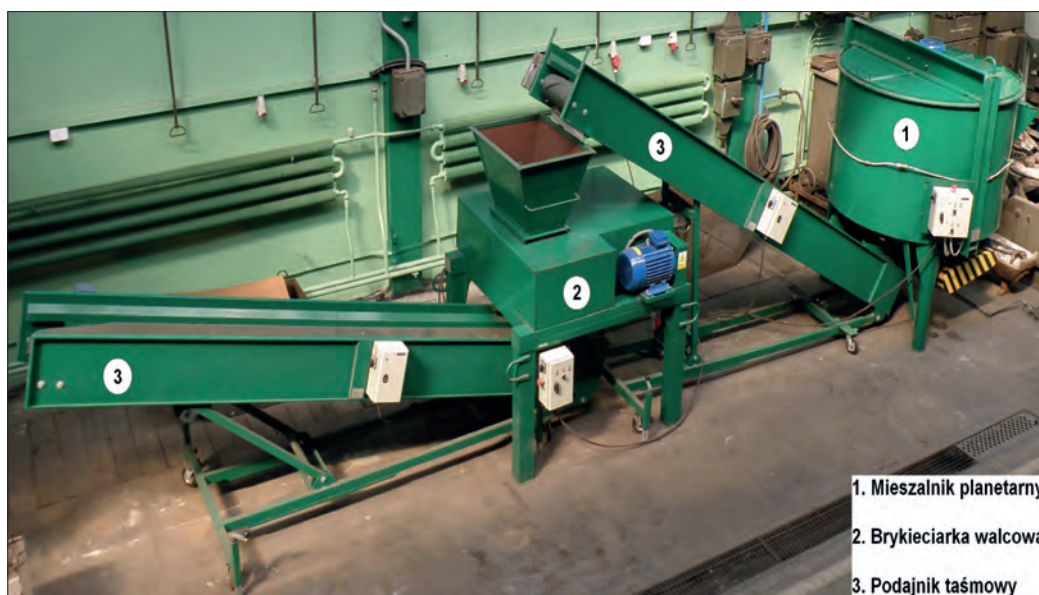
Rys. 3. Laboratoryjna instalacja do brykietowania z prasą walcową
