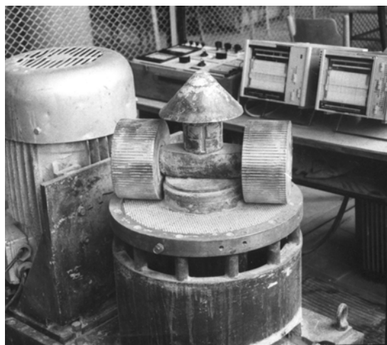
Rys. 2. Schemat budowy granulatora (brykieciarki) z płaską matrycą [1]: A - uniwersalne urządzenie granulujące-brykietujące, B - rejestrator temperatury, C - rejestrator poboru mocy, D - termoelement, 1- dozownik (bezstopniowa regulacja), 2- rolki zagęszczające, 3- nieruchoma płaska matryca, 4- obudowa wału napędowego, 5- wysyp aglomeratu, 6- przekładnia pasowa, 7- podstawa, 8- silnik elektryczny, 9- wał napędowy, 10- nóż obcinający; b) widok uniwersalnego urządzenia granulującego-brykietującego (zdjęty dozownik): dane techniczne; moc - 15 kW, prędkość zespołu rolek - 210 obr/min, wymiary - 970 mm x 600 mm x 1720 mm, szerokość rolki - 102 mm
