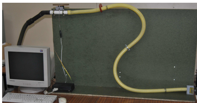
Rys. 2. Fotografia stanowiska laboratoryjnego pomiaru czasu przepływu materiału ziarnistego w pneumatycznym przewodzie nasiennym
