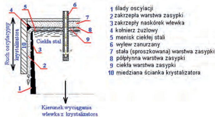
Rys. 3. Schemat strefy przymeniskowej krystalizatora i zachowanie się zasyпки krystalizatorowej wg Bhatta i Millsa [1]
