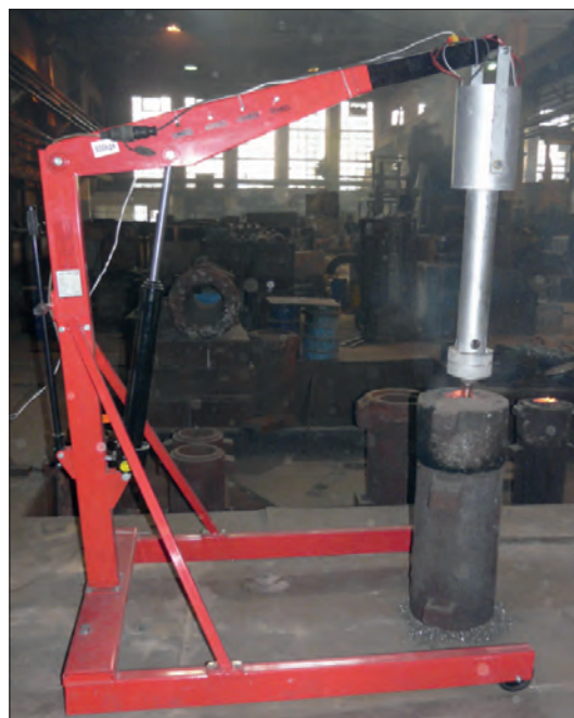
Rys. 1. Falowód głowicy ultradźwiękowej zanurzony w głowie wlewki podczas prób nadźwiękawiania
