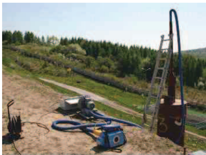
Fot. 1. Zestaw do testów aktywnego odgazowania na składowisku w Przemysłu
