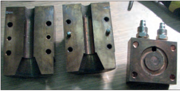
Rys. 2. Widok wlewnicy do odlewania prętów o średnicy 10 mm i długości 50 mm
