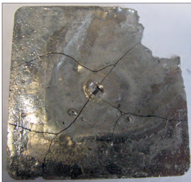
Rys. 5. Płytkę o wymiarach 50x50 mm i grubości około 5 mm odlana ze stopu 2
