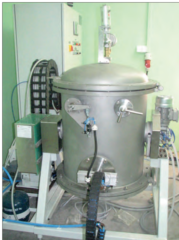
Rys. 1. Stanowisko do wytapiania i odlewania ciśnieniowego stopów amorficznych (strona lewa i przód)
