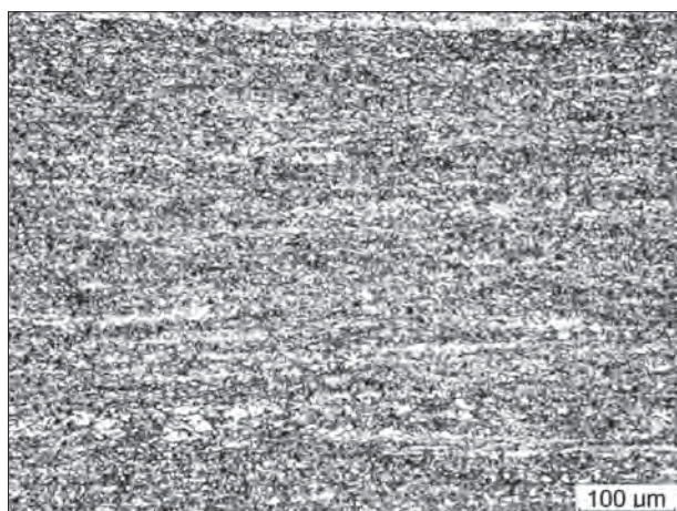
Rys. 4. Mikrostruktura blachy walcowanej z obróbką cieplno-plastyczną i regulowanym chłodzeniem po walcowaniu w module B-LPS.
