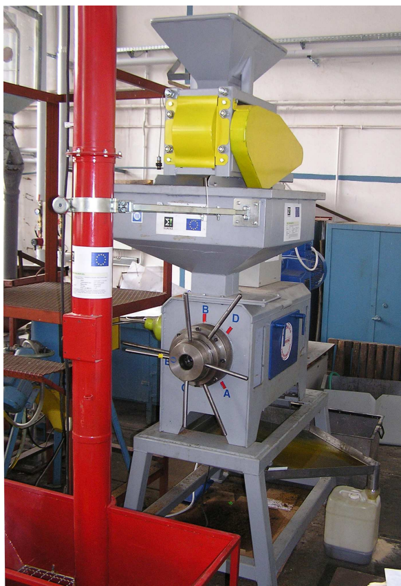
Rys. 1. Prototypowa prasa ślimakowa do wyłaczania oleju z nasion lnianki siewnej
