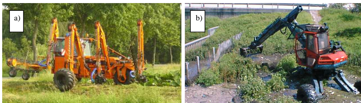
Rys. 3. Przykładowe urządzenia produkcji zachodniej do wykonywania zabiegów renowacyjnych w ciekach wodnych: a) Slope Mower Type 2300 (Berky), b) Spider (McLane Excavating) [10, 13]
