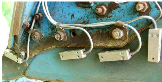
Rys. 3. Lemiesz z zainstalowanymi czujnikami nacisku widziany od strony przeciwnej do strony roboczej Fig. 3. The ploughshare with pressure sensors seen from the side opposite to the working one
