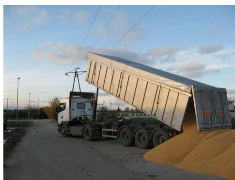
Rys. 3. Przeładunek i transport ziarna: a – wóz przeładowczy PP14 Metaltech Mirosławiec i przyczepa transportowa, b – wyładunek ziarna z samochodu SCANIA 114L z przyczepy Zaslav
