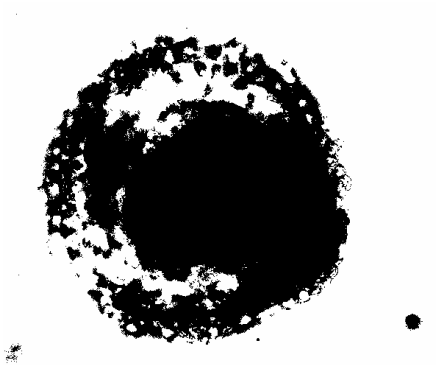
Rys. 4. Obraz binarny z automatycznie wyszukanym progiem o wartości 138; metoda: analiza histogramu
