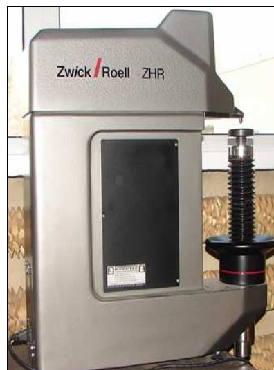
Rys. 7. Twardościomierz „Zwick” Rockwell’a ZHR.4150 AK Fig. 7. Hardness tester “Zwick” Rockwell’a ZHR.4150 AK
