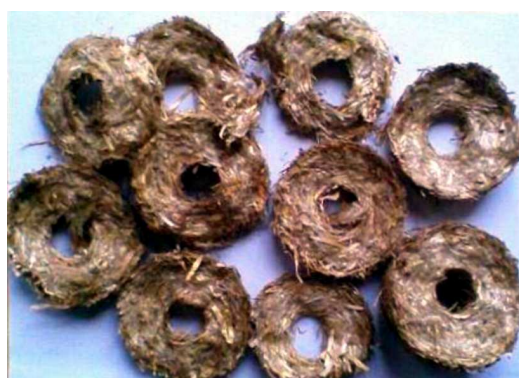
Rys. 6. Rozwarstwienie brykietów Fig. 6. Stratification of briquettes
