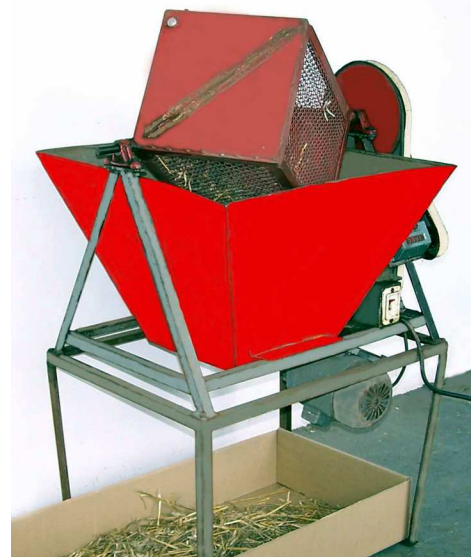
Rys. 3. Stanowisko badawcze do wyznaczania współczynnika trwałości brykietów PIMR Poznań [8]
