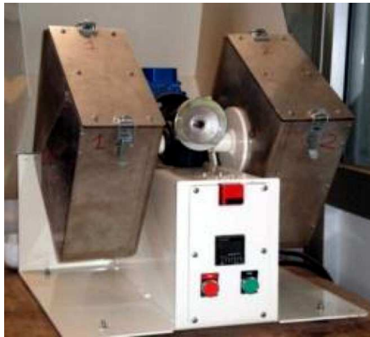
Rys. 2. Stanowisko badawcze duo do wyznaczania współczynnika trwałości peletów [6]
