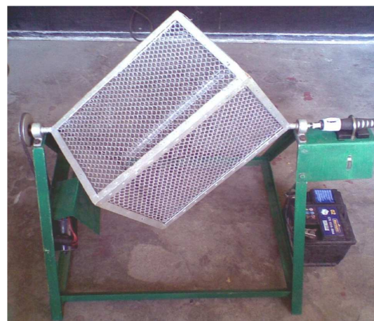
Rys. 4. Stanowisko badawcze do wyznaczania współczynnika trwałości brykietów. Instytut Inżynierii Rolniczej UP Poznań
