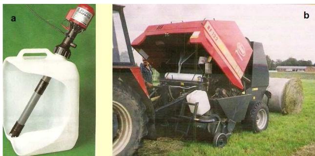
Rys. 5. Aplikator ciśnieniowy Junkkari; a - widok, b - aplikator zamontowany na prasie zwijającej [6] Fig. 5. Pressure applicator Junkkari; a - view, b - applicator mounted on the round baler [6]
