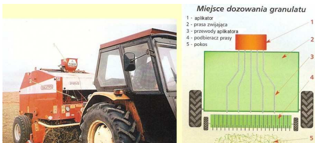
Rys. 6. Aplikator do preparatów stałych granulowanych „Gandy Jumbo” zamontowany na prasie zwijającej Fig. 6. Applicator for solid preparations granulated „Gandy Jumbo” mounted on the round baler
