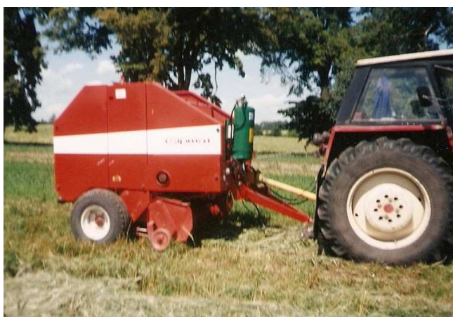
Rys. 2. Aplikacja dodatku w czasie zbioru roślin (aplikator opracowany w UTP w Bydgoszczy) [6] Fig. 2. The application of the addition during harvesting of plants (aplikator worked out in UTP Bydgoszcz) [6]
