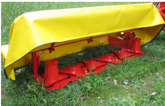
Rys. 3. Prototyp kosiarki tarczowej Fig. 3. Prototype of disc mower
