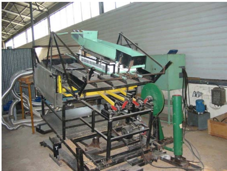
Rys. 2. Widok stanowiska pomiarowego z zainstalowaną sekcją sita żaluzjowego Fig. 2. View of measuring position with shutter sieves' section installed
