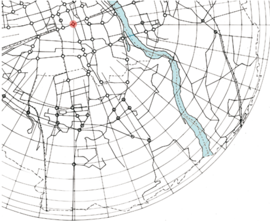
Ryc. 7. Do opracowania schematu w zmiennej skali H.D. Biłowicka (1982) wykorzystano odwzorowanie azymutalne ortograficzne. Na niebiesko oznaczono Wisłę, zaś na czerwono punkt główny konstrukcji czyli skrzyżowanie Al. Jerolimskich i ul. Marszałkowskiej
