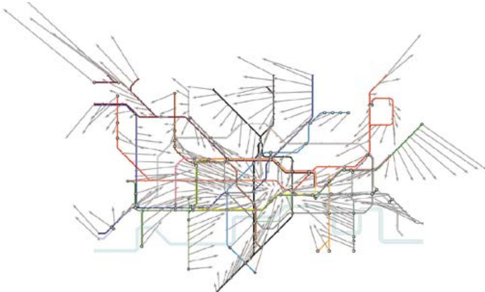
Ryc. 6. Porównanie położenia stacji metra londyńskiego na schemacie i w rzeczywistości wg B. Jenny (2006). W centrum miasta, gdzie zagęszczenie stacji jest największe, linie są rozciągnięte w celu zwiększenia czytelności, zaś na peryferiach, gdzie stacji jest zdecydowanie mniej, linie są położone bliżej siebie. Takie rozwiązanie jest dopuszczalne, ponieważ schematy nie mają skali
