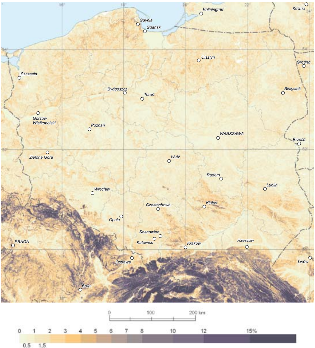
Ryc. 5. Mapa spadków powierzchni terenu Polski opracowana według siatki punktów 125 \times 125 m (ze względów publikacyjnych dane uśredniono w heksagonach o powierzchni 13,81 ha) Fig. 5. Map of slopes prepared on a grid of 125 \times 125 m (for publication purposes data was averaged in hexagons of 13.81 ha)
