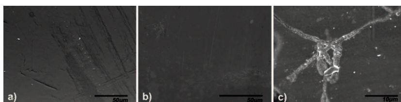
Fot. 4. Struktura folii po 2 miesiącach kompostowania a) folia kontrolna, b) w temperaturze 30°C, c) w temperaturze 48°C
