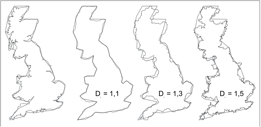
Ryc. 9. Interpolacja fraktalna ze zmiennym parametrem D_f (program własny autora) Fig. 9. Fractal interpolation with a variable D_f parameter (original software by the author)
