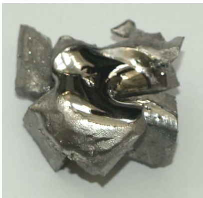
Rys. 4. Widok wolframu (a) oraz chromu (b) po odparowaniu w miedzianym tyglu chłodzonym wodą
