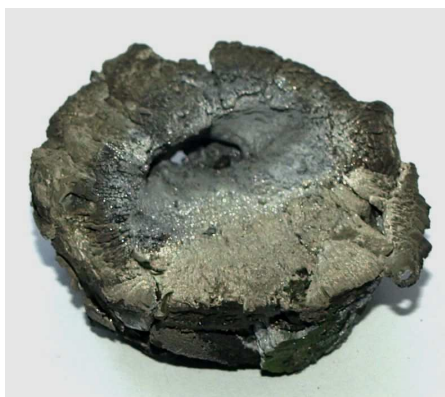
Rys. 4. Widok wolframu (a) oraz chromu (b) po odparowaniu w miedzianym tyglu chłodzonym wodą
