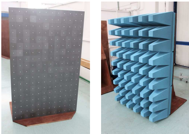
Rys. 3. Ekrany tłumiące (po lewej przed naklejeniem absorberów)
