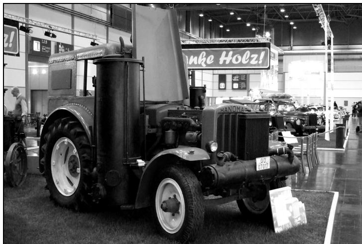
Rys. 6. Ciągnik rolniczy Hanomag z silnikiem wysokoprężnym i instalacją dwupaliwową Fig. 6. Hanomag agricultural tractor with a combustion engine and dual fuel system
