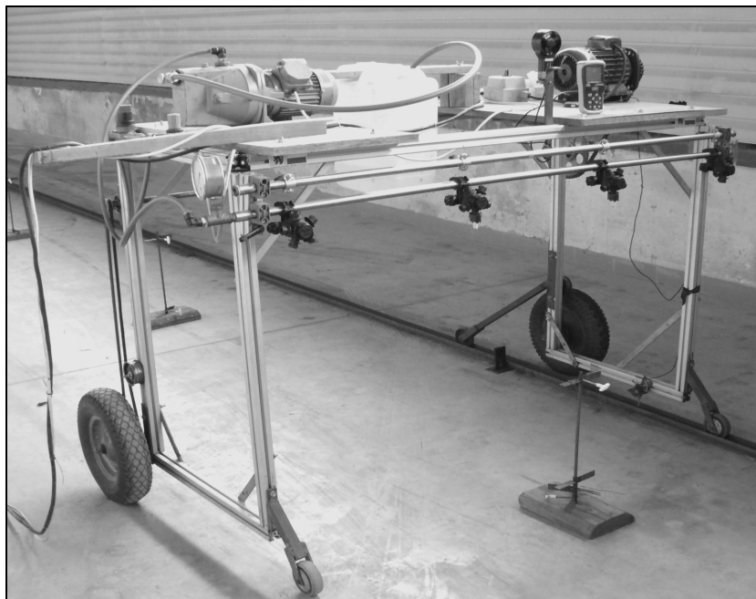
Rys. 2. Widok ogólny nośnika rozpylaczy: 1 – układ cieczowy, 2 – układ jezdny, 3 – anemometr Fig. 2. General view of sprayers carrier: 1 – liquid system, 2 – drive system, 3 – anemometer
