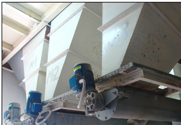
Rys. 1. Komory dozujące surowce paszowe do wagi małej Fig. 1. Chambers dosing fodder raw materials onto a small scale
