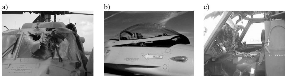
Rys. 4. Uszkodzenia kabiny samolotów wojskowych:
