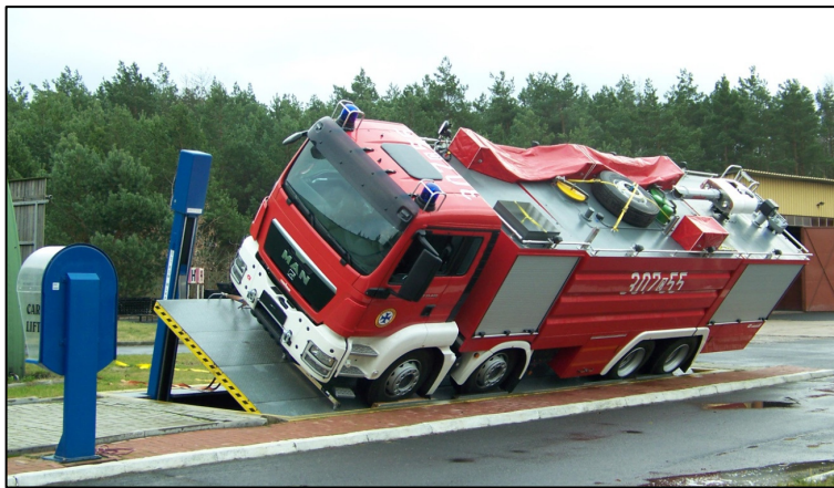
Rys. 3. Badanie granicznego kąta przechyłu bocznego samochodu pożarniczego z wykorzystaniem wychylnej platformy (materiały CNBOP Józefów)
