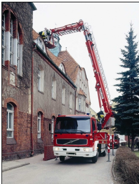
Rys. 2. Podnośnik hydrauliczny BUMAR na podwoziu samochodu VOLVO ( www.bumar.pl )
