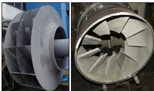
Rys. 10. Powłoki ochronne wykonane na wirniku wentylatora oraz zawirowywaczu dla palnika pyłowego
