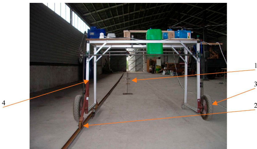
Rys. 1. Widok z góry na sztuczną roślinę z założonymi próbnikami: 1,2 – powierzchnie pionowe najazdowe i odjazdowe ( A_{pi} ), 3 – powierzchnia opryskiwana pozioma ( A_{po} ), 4 – stelaż Fig. 1. Top view on an artificial plant with testers: 1, 2 – approach and depart vertical surfaces ( A_{pi} ), 3 – horizontal sprayed surface ( A_{po} ), 4 – rack
