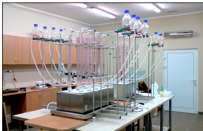
Rys. 4. Aparatura badawcza – zestaw eudiometrów Fig. 4. Test equipment – eudiometers set
