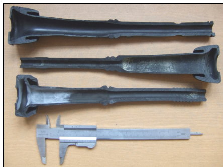
Rys. 1. Pomiar gum strzykowych przy pomocy suwmiarki. Gumy DeLaval 92817401, DeLaval 92811901, ProSquare – BPX
