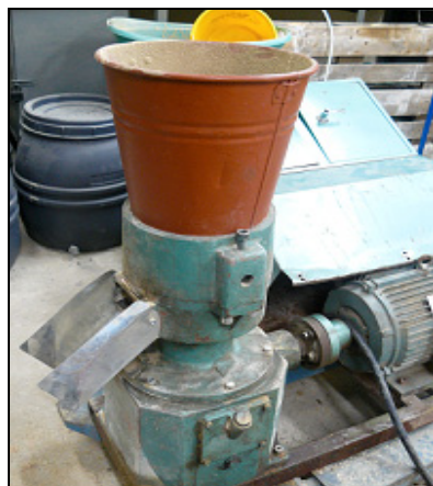
Rys. 1. Pelectarka z dwustronną matrycą płaską Fig. 1. Pellet machine with two-side flat press
