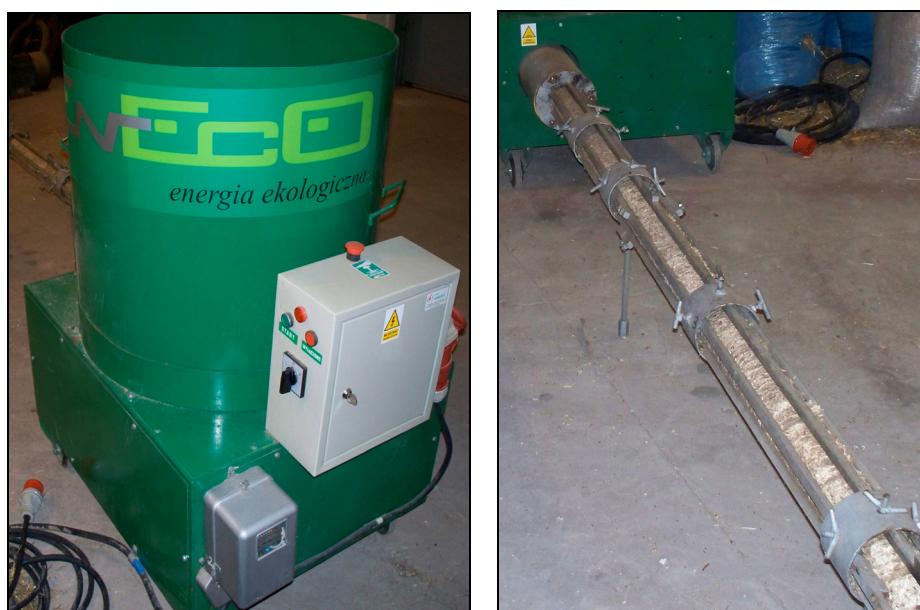
Rys. 1. Brykieciarca ślimakowa JW-08 z prowadnicą brykietów Fig. 1. Screw briquetting machine JW-08 with a briquette guidebar
